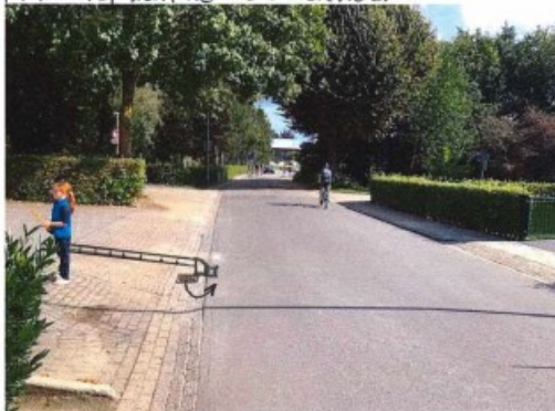
schuine band (5/20x20) zodat inrit bereikbaar blijft. grijze betonsteen tussen in loopstrook
